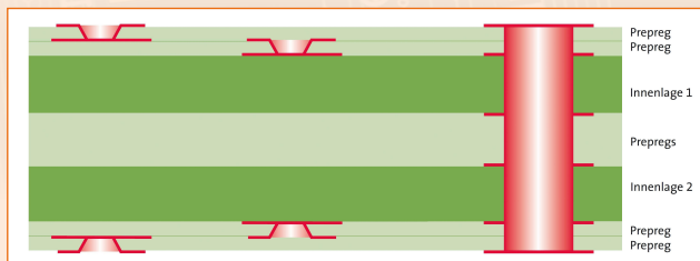
Schematischer Aufbau eines typischen 8-Lagen-Multilayers Quelle: CONTAG
